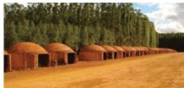
Figura 50 - O modelo mais simples de forno de alvenaria e ainda utilizado pelos pequenos produtores é o forno circular de superfície.
